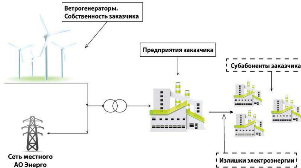
Схема параллельной работы ветрогенераторов с сетью
